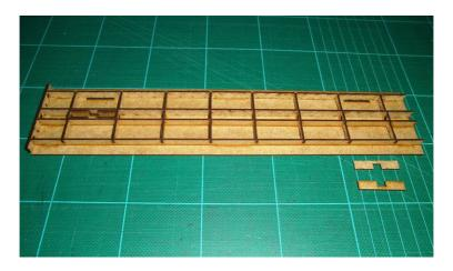
Die Pufferbohle werden in ihre Stelle geklebt, und die Bodenplatte gedoppelt neben die Außen- Längsträgern.
