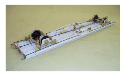
Nachdem das Fahrwerk grundiert ist, wird es mit Graphit schwarz (Ral 9011) eingefärbt.
