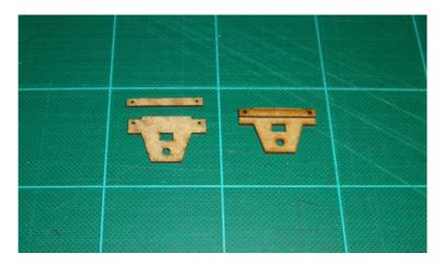
Die Innen- Längsträger werden gedoppelt (senkrecht) als Stütz-Führung für die Bremshebel.
