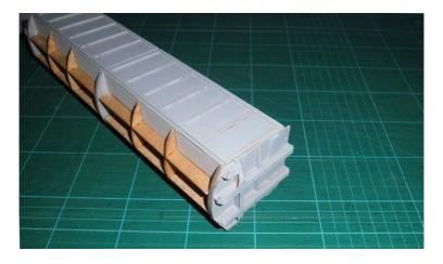
Die Dachplatte in Sperrholz werden gedoppelt, bewässert und eingespannt in einem Wasserrohr zum vorbiegen.
