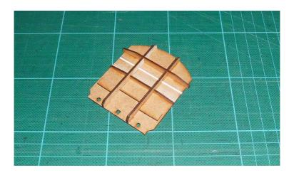
Auf das Rahmenwerk der Stirnseite kommt eine Profilwand, (ausgelasert aus Mica) draufgeklebt.
