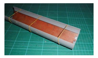
Die Dachplatten werden jetzt zusammengeklebt und angepresst mit ein PVC Drück Rohr (Durchmesser 63 mm)
